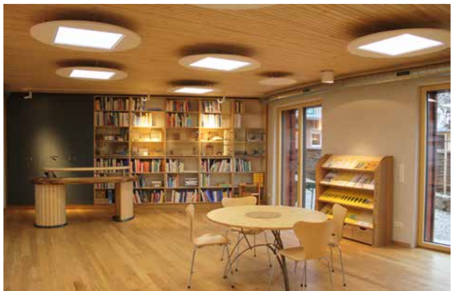
Gesundes Licht durch flimmerfreie LED, Tageslichtlenk-Stores und höchst lichtdurchlässige Passivhaus-Fenster.
